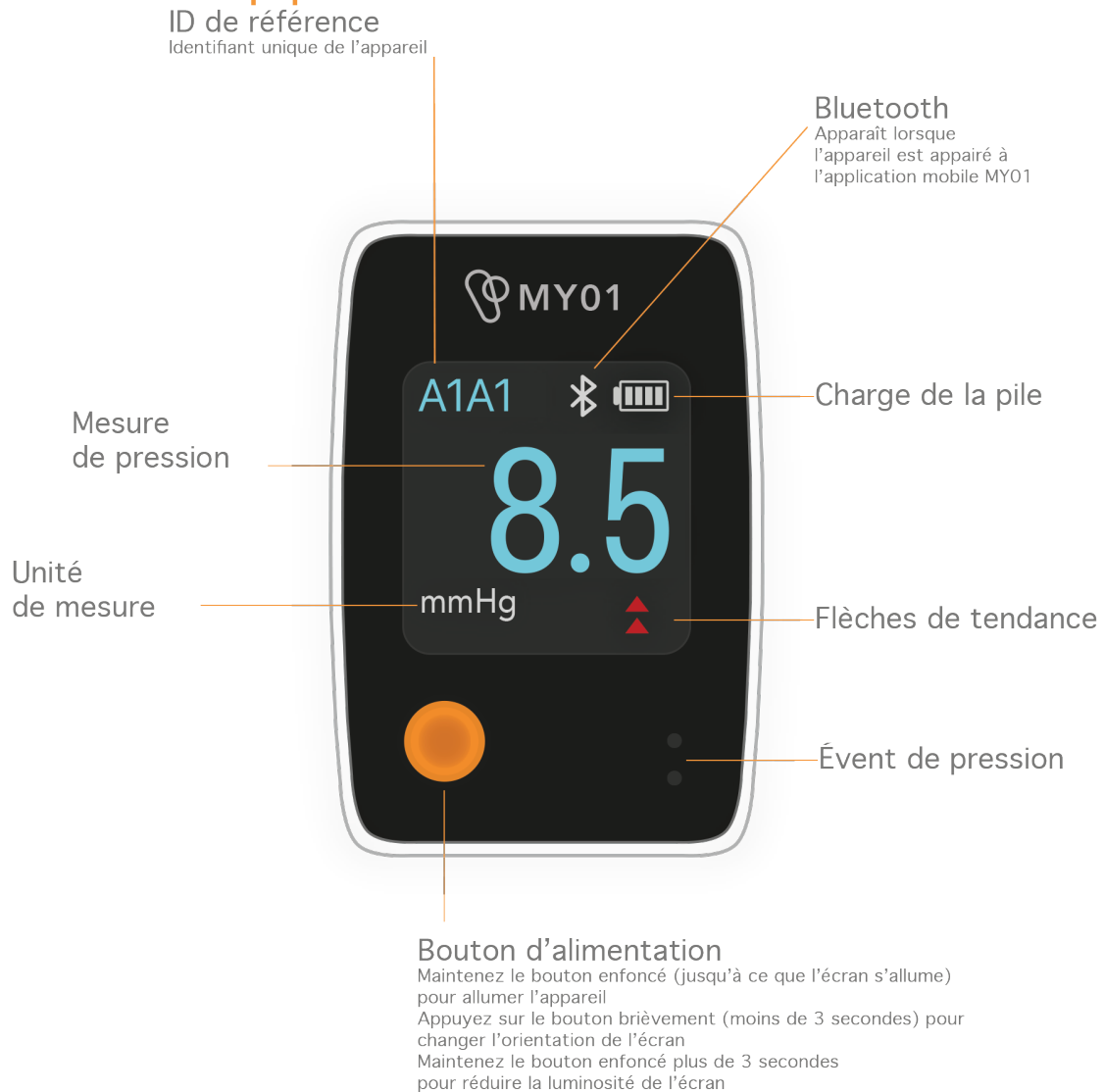
Figure 4: Commandes de l'appareil et icônes de l'écran
