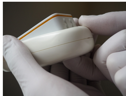
Figure 15: Éjection du moniteur de pression
