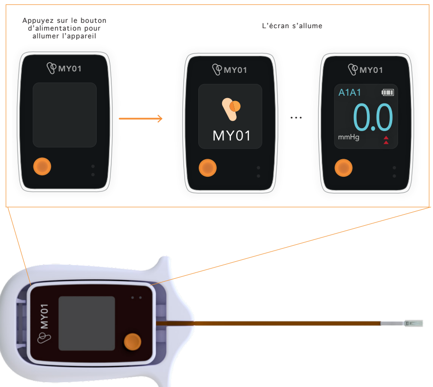
Figure 12: Retirer le Bouchon de l'aiguille et mise en marche du moniteur de pression
