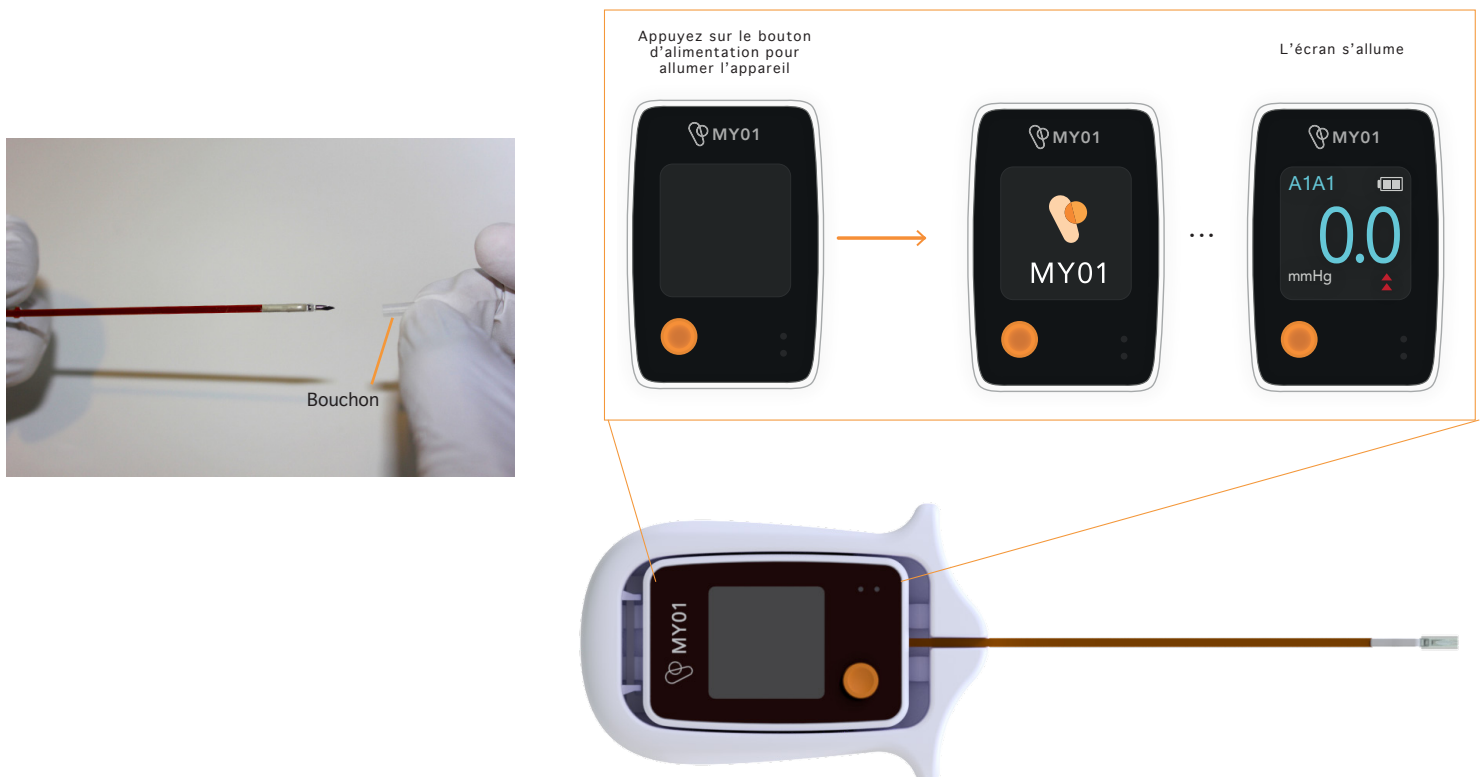
Figure 6: Retirer le Bouchon de l'aiguille et mise en marche du moniteur de pression
