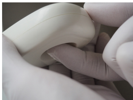
Figure 9: Éjection du moniteur de pression
