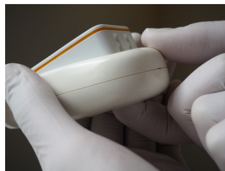
Figure 9: Éjection du moniteur de pression
